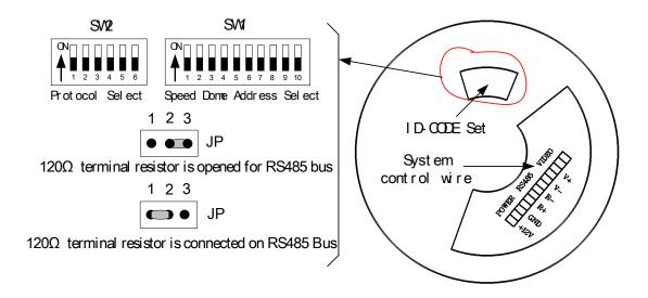
Kameranın alt bölümünden switchlere ulaşmanız mümkündür. DIŞ ORTAM kamera için geçerli olan bütün ayarlar İÇ ORTAM içinde geçerlidir.
